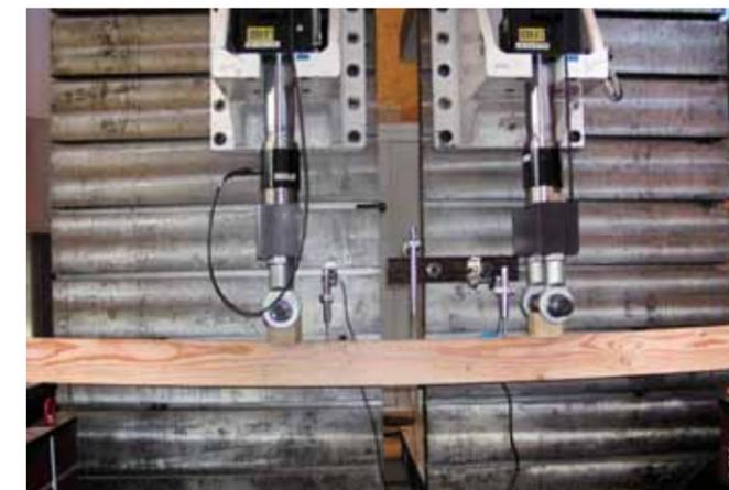
Test de résistance mécanique sur un sciage de douglas.
