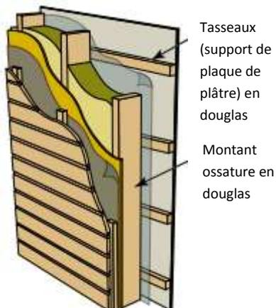
**Solution 2 :** Structure primaire avec doublage isolant intérieur
